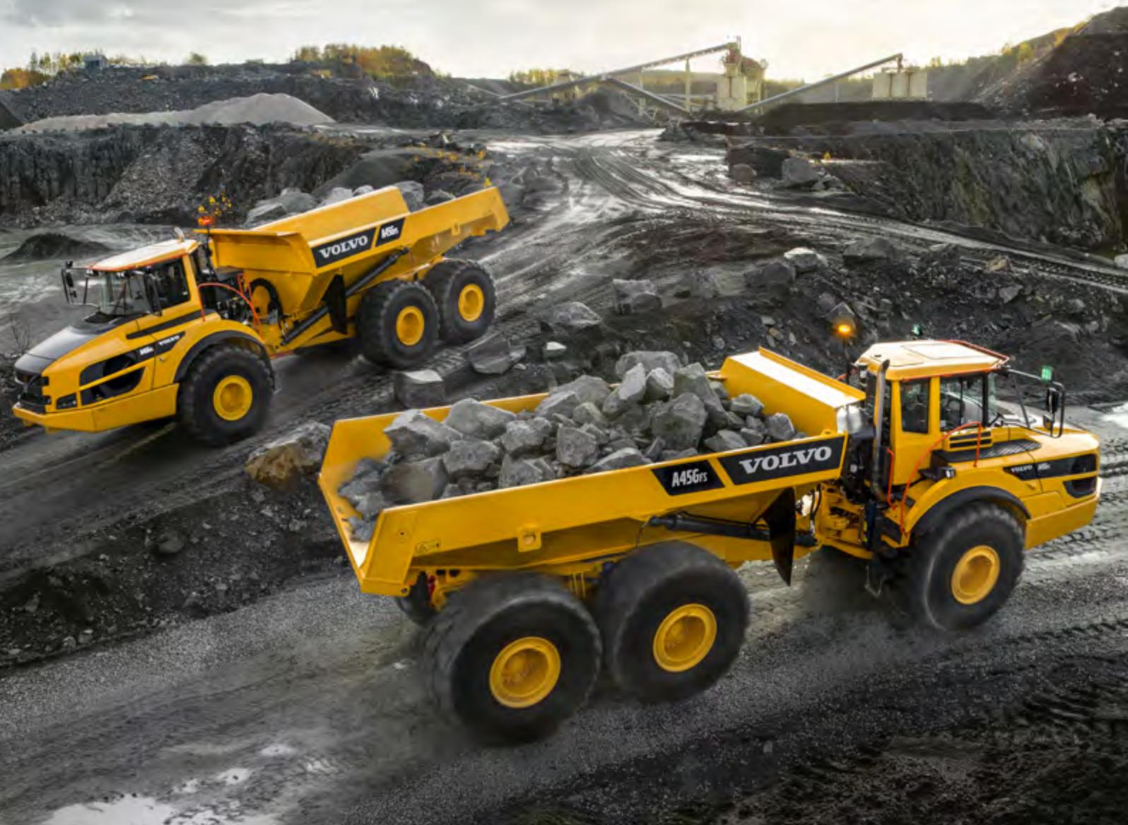
Volvo knickgelenkte Dumper 41 Tonnen 485 PS
