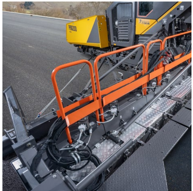
Schlauch- und Kabelkanal
